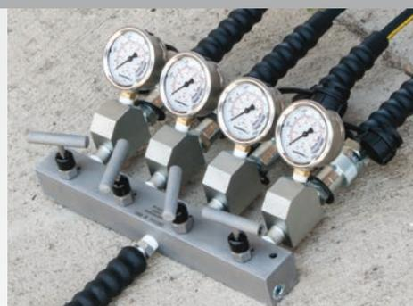
Viele dieser Anwendungen erfordern die Synchronisation mehrerer Hydraulikzylinder. Enerpac bietet zahlreiche Lösungen, um diese Werkzeuge zu steuern und zu synchronisieren. Diese Lösungen reichen vom einfachen AM41-Verteiler und GA45GC-Manometer-Set bis zu präzisen, integrierten Drosselventilen der Pumpe mit geteiltem Förderstrom der SFP-Serie oder Synchronhubanlage der EVO-Serie.
